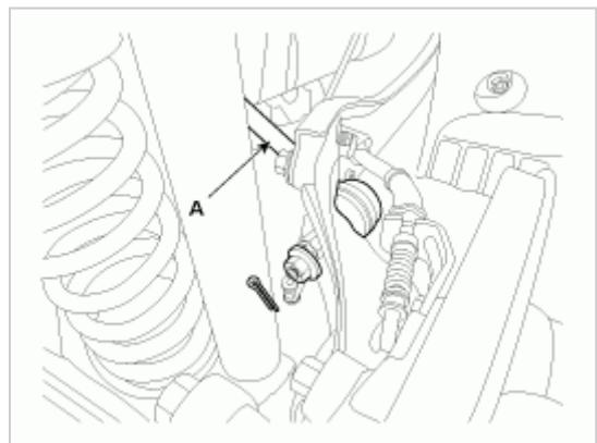
3. 拧下螺栓与螺母，从副车架拆卸后辅助臂 (A)。
